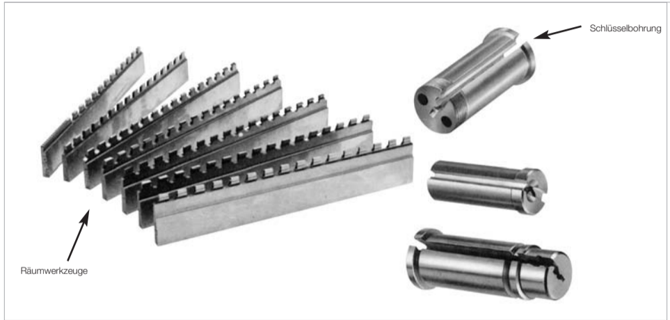
Räumen von Schlüsselbohrungen
