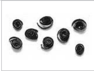
Dicke, schwere oder blau angelaufene Späne
