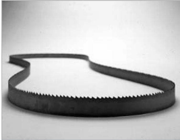
Beim Bandsägen schneidet ein endloses Bandsägeblatt in eine Richtung und in einem gleichmäßigen Schneidvorgang mit gleichmäßig verteilter, niedriger Belastung pro Schneidzahn. Die erzeugten Späne haben konstante Dicken.
