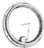
Engrenages à denture intérieure
