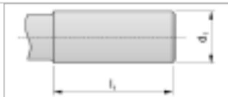
**Gambo cilindrico liscio**
